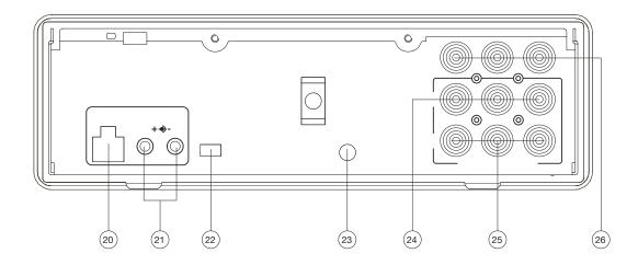
20. DC 12V INPUT Socket 21. DC 12V OUTPUT Socket 22. AV OUTPUT TYPE Switch 23. REMOTE Socket 24. AUDIO/VIDEO OUTPUT 1 25. AUDIO/VIDEO OUTPUT 2 26. AUDIO/VIDEO INPUT 2
